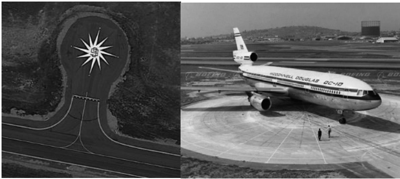
Figura 10. Rosa de Calibración de la Brújula (Izq.) y Ejemplo del proceso de calibración (Der).
