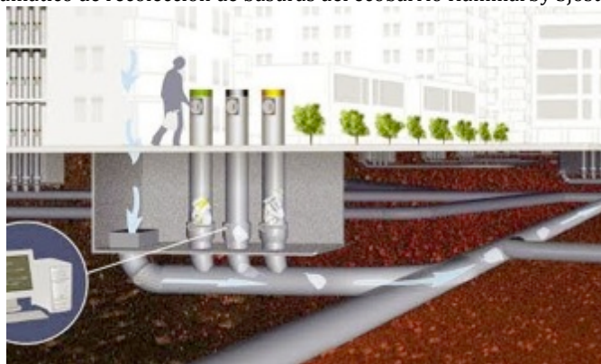
Imagen 2. Sistema neumático de recolección de basuras del ecobarrio Hammarby Sjöstad en Estocolmo, Suecia
