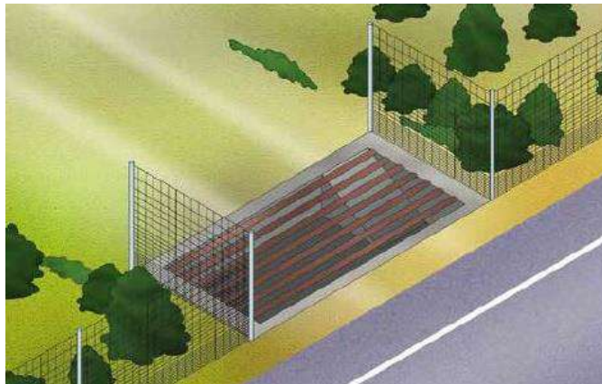
Figura 73: Puerta con pasaganado en apertura de la barrera para paso de fauna silvestre.
