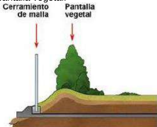
Figura 65: Combinación de barrera y pantalla vegetal.
