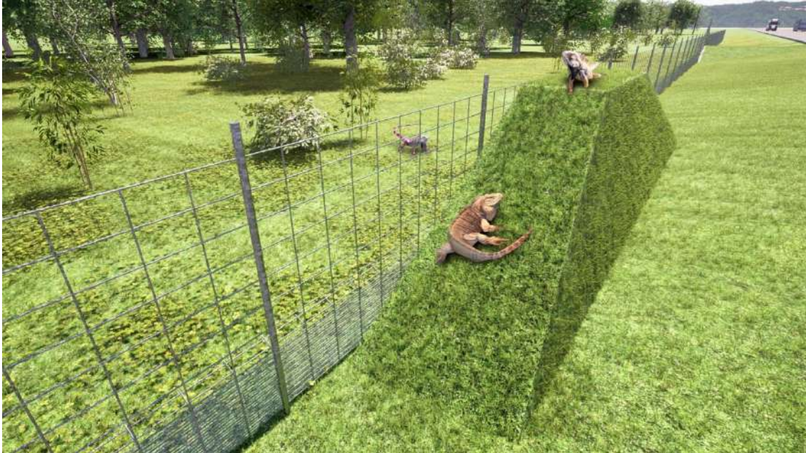
Figura 74: Ejemplo de rampa de escape, en tierra.
